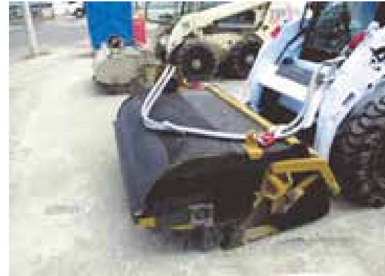
動力機具加裝隔音棉，可阻隔噪音並減少對施工人員因噪音造成的傷害
